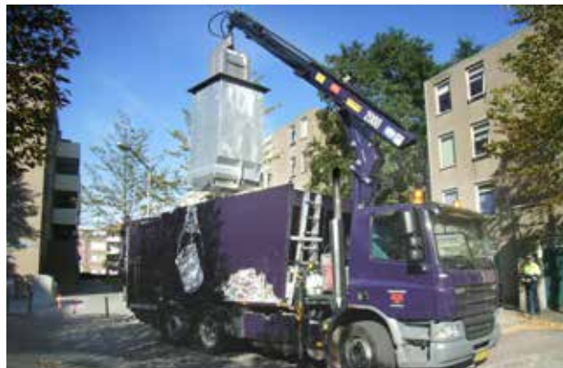
Containerens bunn utløses og avfallet faller ut
