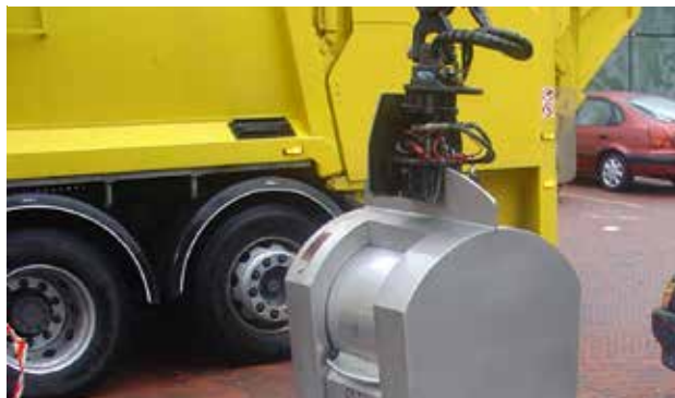
Kranen fra renovasjonsvognen fastgjøres til løfteøyet
